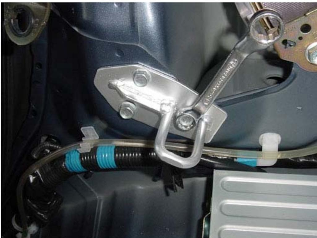
14. リラックスキットのストライカーがオフセットした分、内装が干渉する為画像の黄色で示した部分を切除します。約 10mm×30mm 程度です。一旦電動ドリルで穴明けをした後、カッターナイフなどで切除すると綺麗に出来ます。
