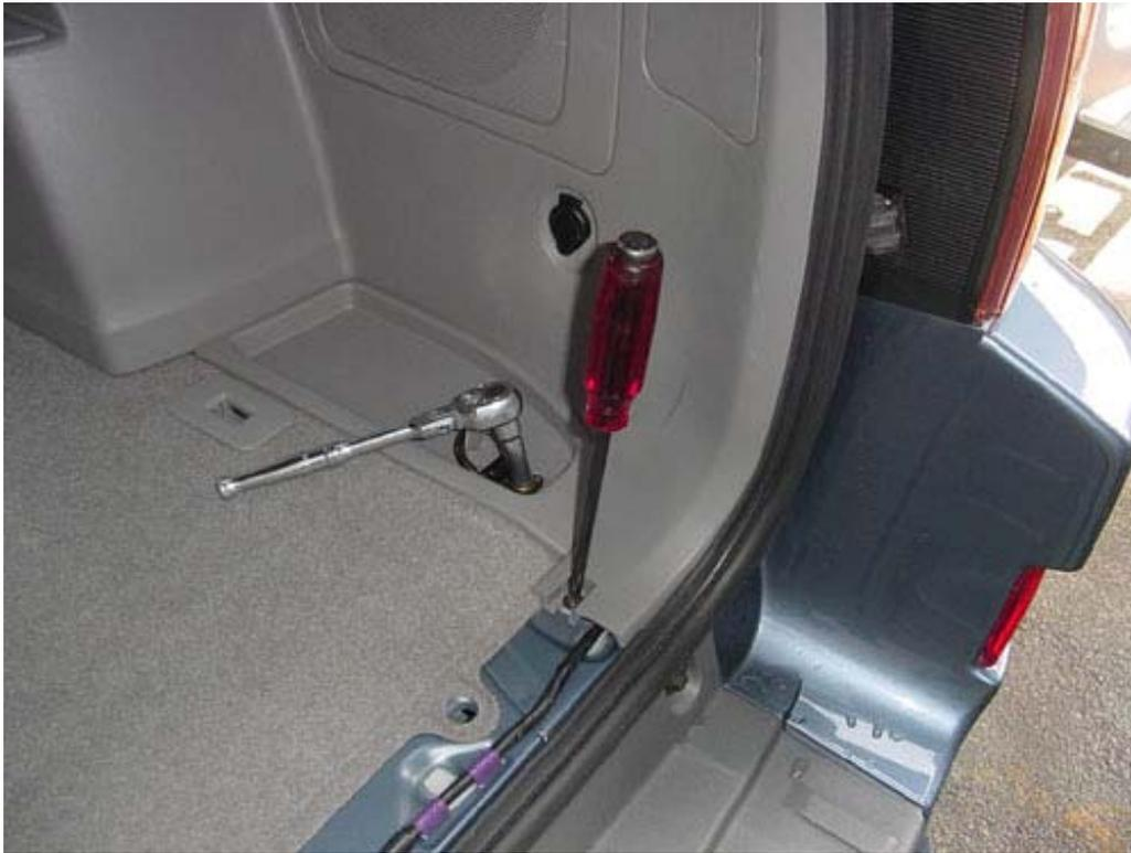
5. 荷室後端にある樹脂製のネットホルダーを外します。画像のように予め外側先端部分を引き抜き、全体を引き抜きます。ネジ等はありません。
