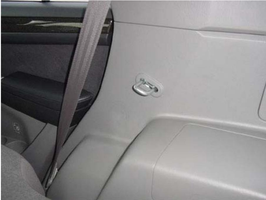
1. まずこの部分のネジを10mmソケットレンチにて左右とも外します。
