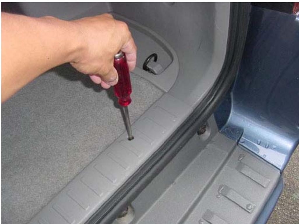
4. 樹脂部品を外すと、またネジが現れます。このネジをプラスドライバーで、また、樹脂製トレイ部に有るタイダウンフックを 10mm ソケットレンチで外します。この時樹脂製トレイも外れます。
