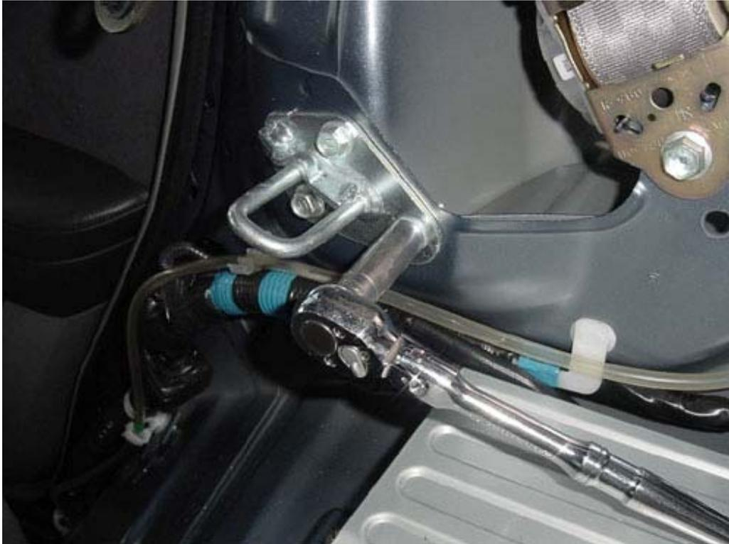
13. リラックスキットのストライカーを取り付けます。ボルトは外した物を使用。
