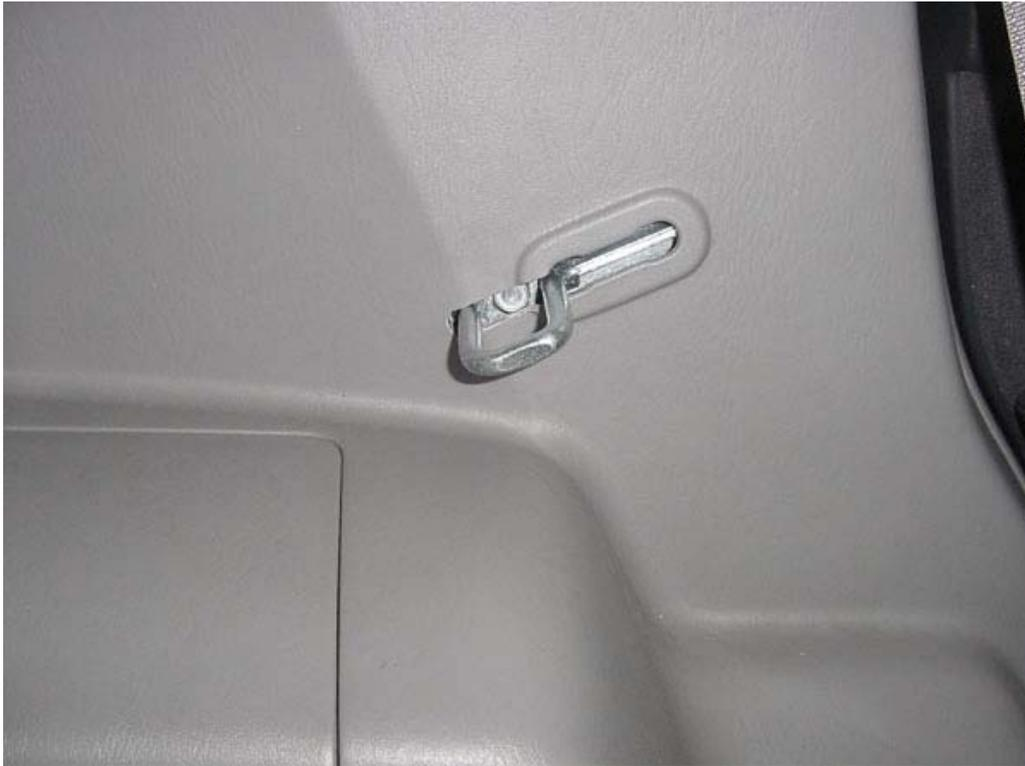
17. この状態でシートを固定してみてください。シートは内装との隙間はほとんど無い状態となりますが、車両によってはシートバックが内装に押し当てられる状態になります。この場合取り付けの状態によって内装が一部浮いてしまう場合がありますが、シートヒンジ部分のネジ穴ガタ、リラックスキットのネジ穴ガタがそれぞれあり、調整する事で改善されます。
