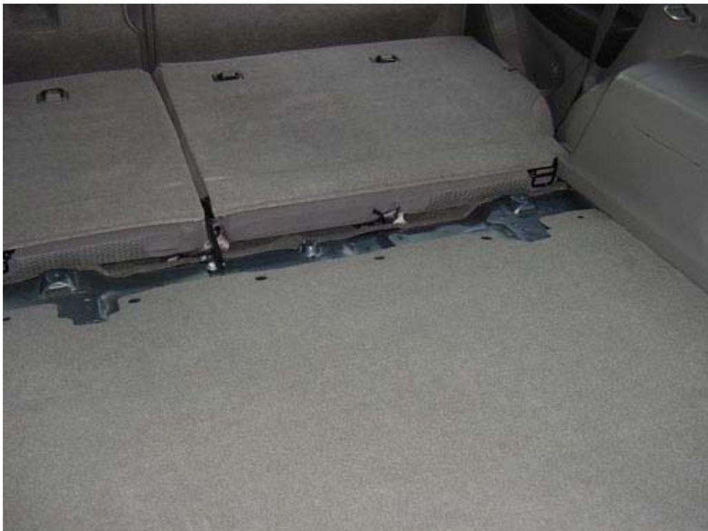
3. 荷室後端のこのネジをプラスドライバーで外し、樹脂製の部品を外します。ネジを外しても各部がハメコミになっています。
